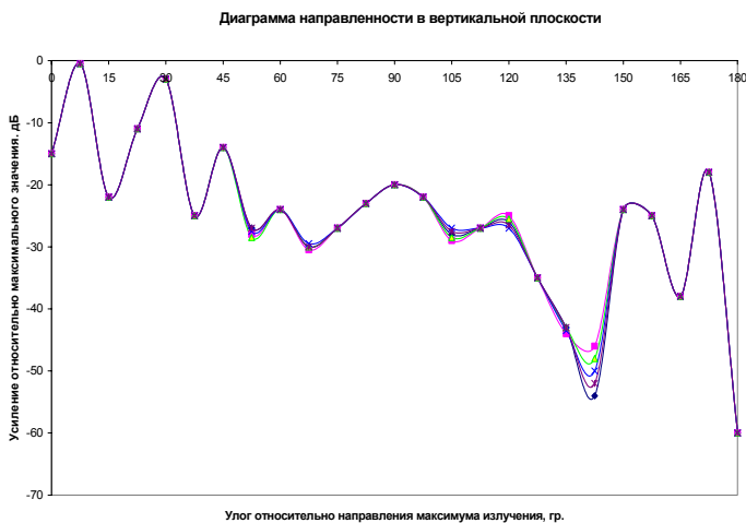
Рис. 1б – ДН в вертикальной плоскости верхней антенны стэка (высота 32 м).
