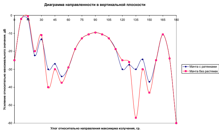
Рис. 4 – ДН стэка в вертикальной плоскости для случая с растяжками и без них
