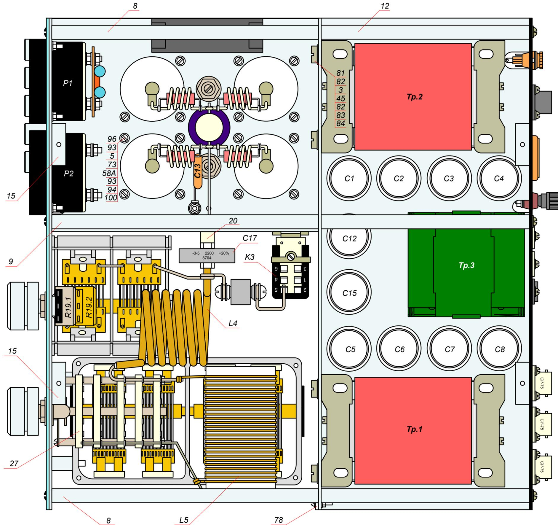
Рис. 15Е. Сборочный чертёж усилителя DVA-300Е. Вид сверху со снятыми верхней и нижней крышками.
